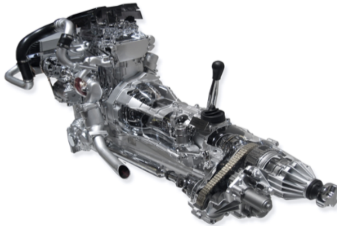
Figura 1. Características producto-proceso: (i) 747 piezas y 330 referencias · (ii) 140 operaciones de montaje · (iii) 42 operarios para un turno de 135 motores · (iv) 9 tipos de motores de 3 familias: 4x4 (p1 a p3), furgonetas (p4, p5) y camiones MT (p6 a p9) · (v) Turno efectivo 6h 45' y ciclo de 3'.
